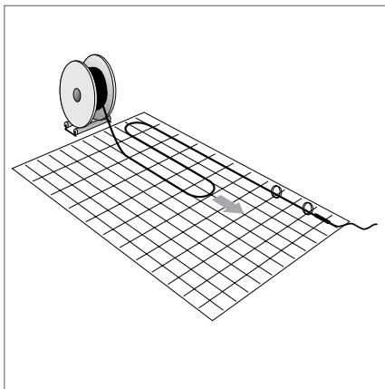
**Замечание:** на сгибе греющий кабель встает на ребро, даже если на прямом участке он лежал плоско. Это не влияет на производительность системы.
